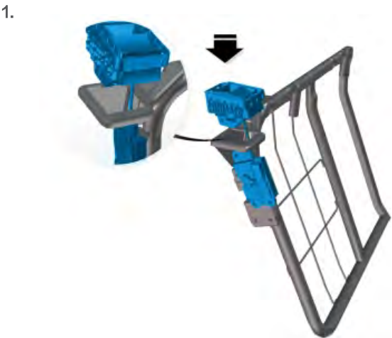
将座椅靠背锁和倾斜器把手安装到新的座椅靠背框架上。
