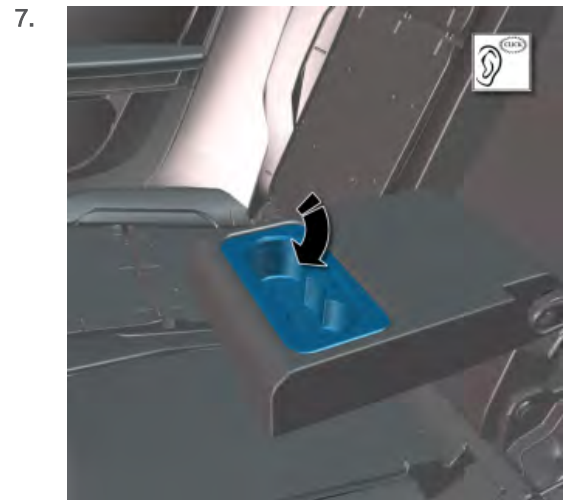
安装后排扶手杯托。
