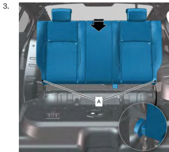
安装座椅靠背。 对准两侧定位点。
