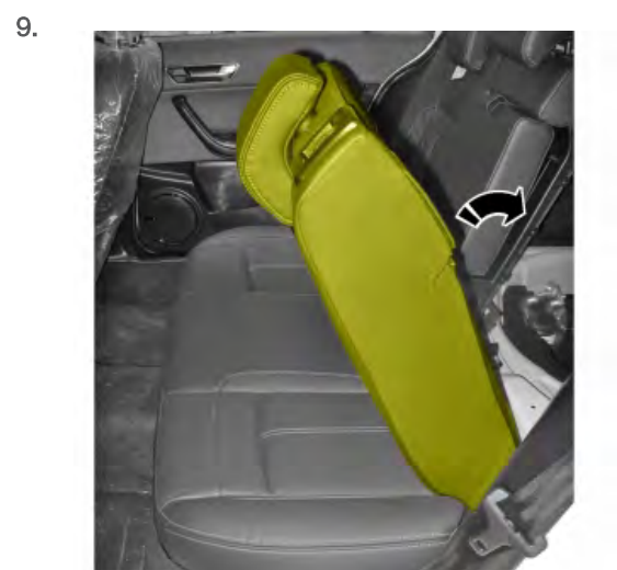
将 40% 座椅靠背移动到水平位置。
