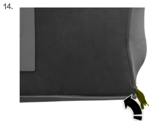
关闭 60% 右后座椅靠背拉链。
