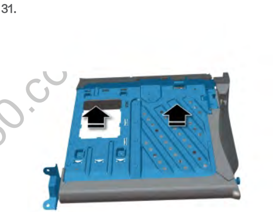
将座椅框架从座椅泡沫抬起一小段距离。 取下四个头枕套。
