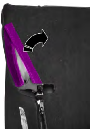
卸下 40% 左后座椅靠背紧固件。
