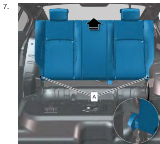
从两个侧面定位点拆下座椅靠背。
