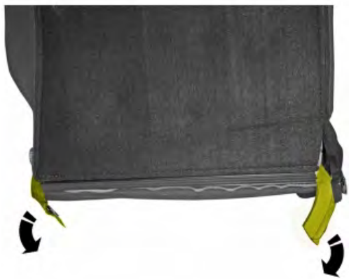
释放两个 40% 后排座椅靠背座椅拉链。
