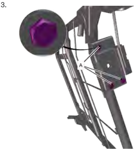
安装三个紧固件。 拧至 10 Nm。
