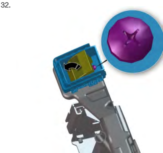
向前移动座椅靠背倾斜器手柄。 卸下紧固件。
