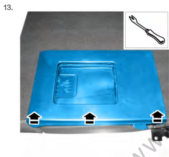
卸下后排座椅扶手开口饰带盖。
