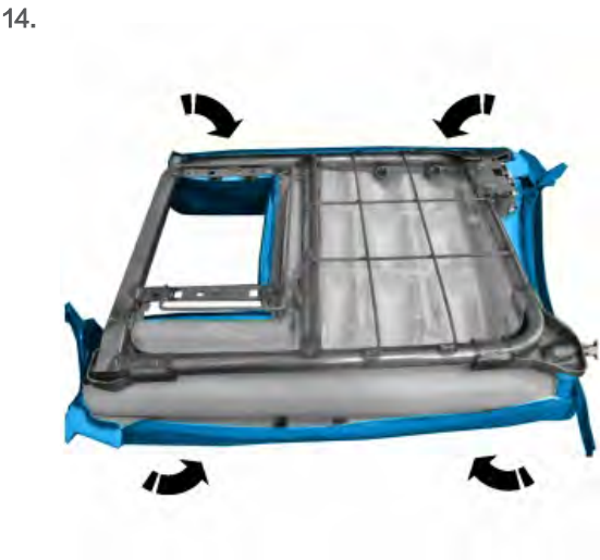
安装 60% 后排座椅靠背泡沫和盖。
