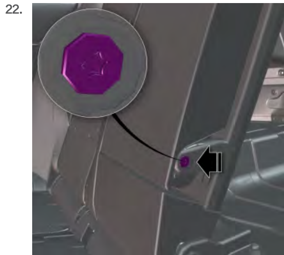
安装扶手紧固件。 拧至 10 Nm。
