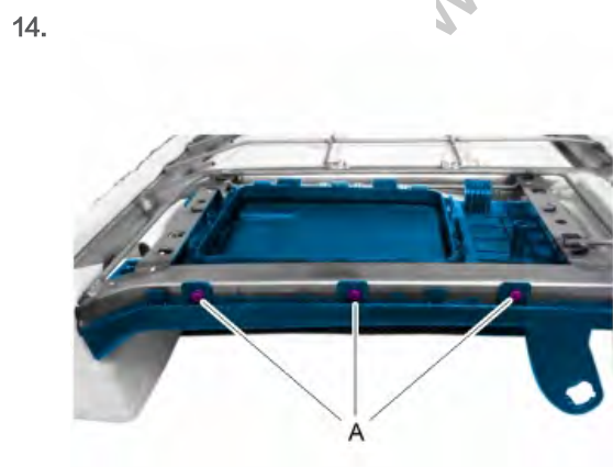
卸下后排座椅扶手开口饰带盖。
