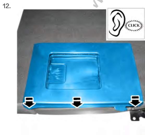
安装后排座椅靠背座垫扶手开口饰带盖。
