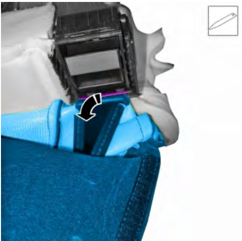
从后排座椅释放把手卸下 40% 后排座椅盖前紧固件。
