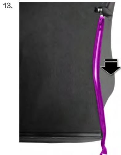
关闭 60% 右后座椅靠背拉链。
